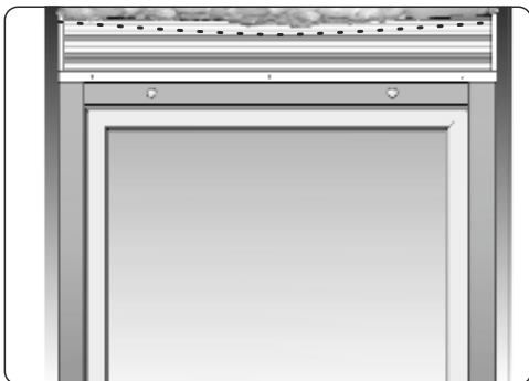
- ugięcie górnego profilu skrzynki .
